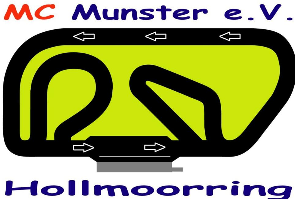
**Strecke:** permanente Asphalt – Rennstrecke; Länge ca. 260m; Breite ca. 4,0m
